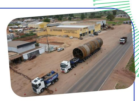
A nova fábrica da Suzano contará com dois fornos de cal, cada um pesando mais de 600 toneladas. Um forno de cal pode atingir uma temperatura interna de 1 mil graus quando aquecido e é um dos componentes do processo de produção de celulose, sendo responsável pela recuperação da cal utilizada na fabricação de soda cáustica que é utilizada no cozimento da madeira.
