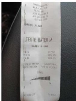
Verificar e anotar a carga da bateria de chumbo, com o Analisador de Bateria Portátil. Anexar a impressão do comprovante a este checklist. Para critérios de aprovação / recarga seguir
